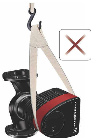
Obr. 6 Nesprávne zdvíhanie čerpadla
