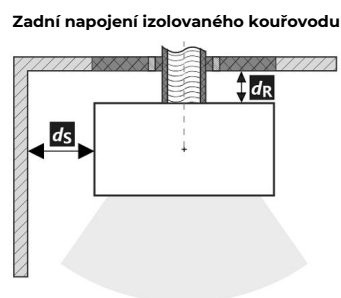
Prostup kouřovodu stěnou z hořlavé hmoty ČSN 06 1008
