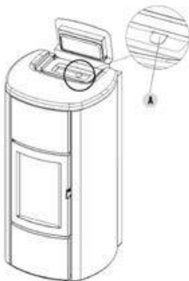
Obrázok 64 – Páka na čistenie výmenníka (Idro Prince 3 16-23-23 H 2 O, Aquos 3 16-23-23 H 2 O, Idron 16-22 Airtight, Hidrofire 22.8)
