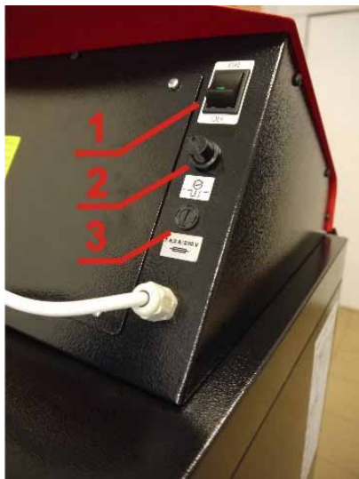
Obr. 17 1 – hlavný vypínač, 2 – havarijný termostat, 3 – poistka (F6,3A)
