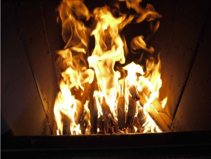
Obr. 11 Dostatočne rozhorená základná vrstva
